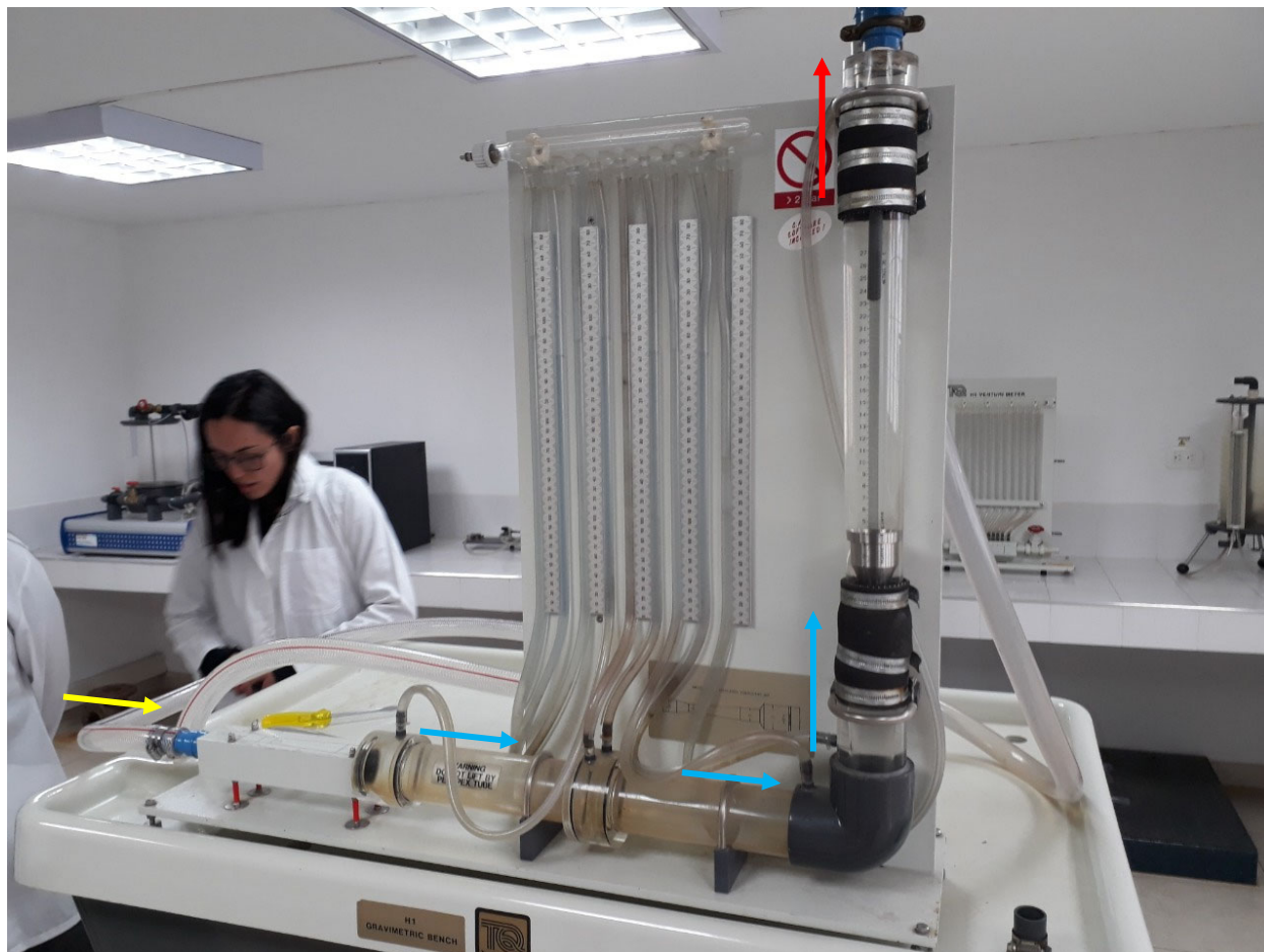
Fig. 6. Montaje de prueba: Venturi, Placa de Orificio, Codo y Rotámetro. Las flechas muestran el ingreso de flujo al Venturi (amarillo), los trayectos de conexión (azul) y la salida (rojo).
