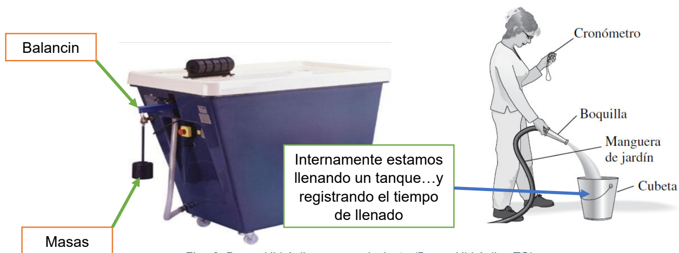
Fig. 3. Banco Hidráulico y su equivalente (Banco Hidráulico TQ).
